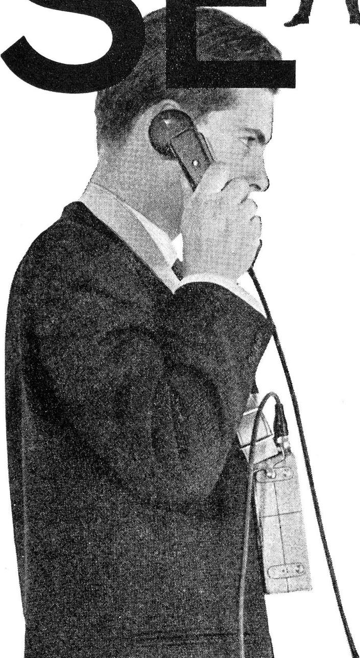
SE 18: ein zuverlässiges, handliches Kleinfunkgerät der Autophon: misst nur 19,8 x 16,6 x 5,5 cm; wiegt nur 2,6 kg. Reichweite: 20 km in offenem Gelände, 3 km im Innern von Ortschaften. Leistung: 110 Stunden reine Empfangszeit, 25 Stunden bei 10% Sendezeit. Stromquelle: Nickel-Cadmium Akkumulator, beliebig oft aufladbar.
