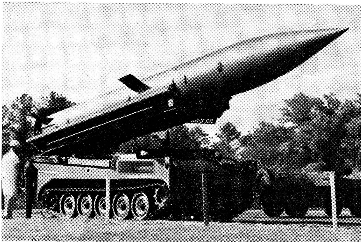
Das Bild zeigt ein Trägerfahrzeug der neuen amerikanischen Lenkwaffe PERSHING mit aufgesetzter Transport-, Aufrichte- und Abschussvorrichtung. Es ist mit einem Chrysler-Motor versehen und hat bei einer Geschwindigkeit von 64 km/Std. einen Aktionsradius von 320 km.
