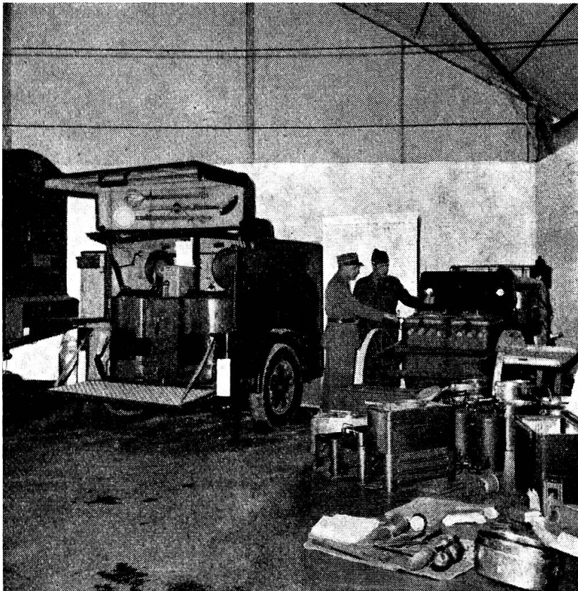
Anhängerküche Mod. 1942, Fahrküche Mod. 1909 und Benzinvergaser
