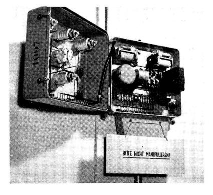
Hier die Innenansicht des Zusatzgerätes EXB2, wie es verbunden mit dem Überwachungsgerät, in einem Bureau- oder Schutzraum montiert werden kann. Rechts aussen ist das Kontaktwerk sichtbar, das den Alarm erst nach drei in ununterbrochener Reihenfolge eingetroffenen Impulsen auslöst und damit jeden falschen Alarm ausschliesst.
