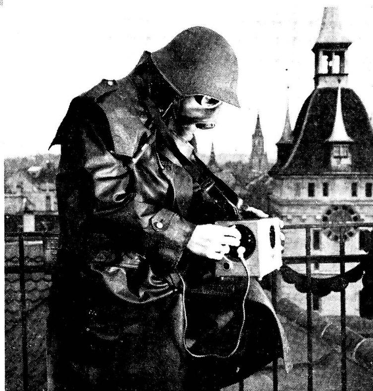
Dem Alarm durch das Überwachungsgerät folgt die Messung der Stärke der Radioaktivität mit dem Messgerät. Ein Vorgang, der alle 30 Minuten wiederholt und gemeldet werden muss.
