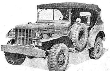
Geländepersonenwagen Dodge,  $4\times4$  (mit Vierradantrieb), Tragkraft  $^3/_4$ t
