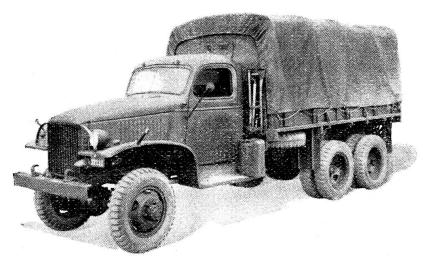
Geländelastwagen GMC,  $6\times 6$  (Sechsradantrieb),  $2^{1/2}$  t
