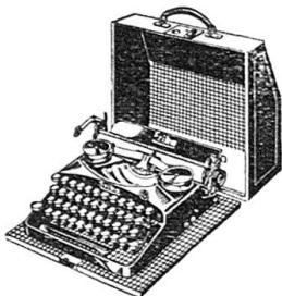
mit den modernen Vorrichtungen: Normale 4reihige Tastatur, normale Walzenbreite, langer und bequemer Zeilenschalthebel, Randlösetaste, Walzenfreilauf, Rücktaste, automatische Farbbandumschaltung, 10 m langes Einfarbenband, dreifache Zeilenschaltung usw.
