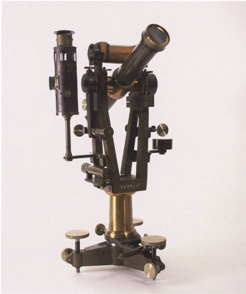
2 Der Simplontheodolit. Beim Bau des Simplontunnels begannen die Arbeiten am Nord- und Südportal gleichzeitig. Damit man sich in der Mitte des Tunnels traf, musste die Tunnelachse genau berechnet und dann im Baufortschritt laufend neu eingemessen werden. Dazu dienten vier von Kern gebaute Absteckungstheodoliten. Zwei grosse (wie der hier Abgebildete) standen vor dem Nord- und vor dem Südportal. Mit ihnen konnte bis zu zwei Kilometer in den Tunnel hinein visiert werden. Im Tunnelinneren kamen dann zwei kleinere Theodoliten zum Einsatz (Foto: Stadtmuseum Aarau, Sammlung Kern).
