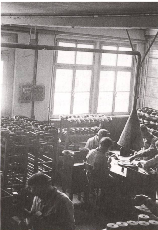
5 Blick in die Pecherei. Diese Art der Produktion wurde vor allem für Besen eingesetzt. Ein Büschel Pferdehaar wurde mit einem Draht zusammengebunden, in flüssiges Pech getaucht und ins vorgebohrte Loch gesteckt. Dort klebte dann der Besatz fest (Bild: Bürstenfabrik Walther AG, Bestand Industriemuseum).
