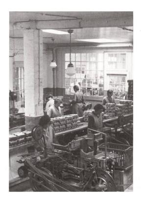
4 Die Automatenstanzerei: An diesen Arbeitsplätzen wurde der Besatz in die vorgebohrten Löcher eingefügt. Hier arbeiteten meistens junge Frauen, da sie schneller waren als die Männer. Für jeden Auftrag mussten die Maschinen von den Mechanikern neu eingerichtet werden. Im Museum wird der Vorgang auf einer Maschine von 1910 weitgehend im Handbetrieb gezeigt (Bild: Bürstenfabrik Walther AG, Bestand Industriemuseum).
