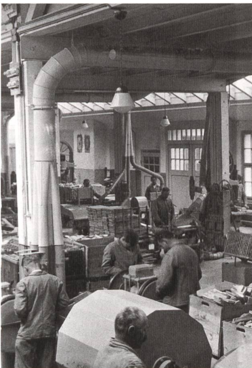
3 In der Hölzermacherei wurden Bürstenhölzer zugeschnitten und die Löcher gebohrt. Hier arbeiteten zum grössten Teil Männer (Bild: Bürstenfabrik Walther AG, Bestand Industriemuseum).
