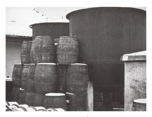
5 Die konventionelle Seife wird aus tierischen und pflanzlichen Ölen und Fetten durch Verseifung mit Natronoder Kalilauge hergestellt. In den 200-Kilogramm-Eisenfässern auf dem Fabrikhof der «Seifi» lagern unter anderem Rinderspeisetalg, Schweineschmalz und Kokosöl. Je nach Endprodukt und Auftrag werden weitere Rohmaterialien zugekauft.
