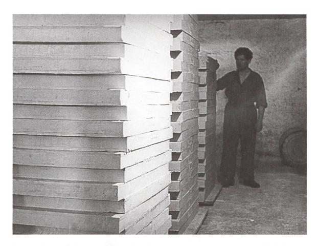
7 Die aus dem Kessel abgezogene heisse Seife wird in Platten zu 50 Kilogramm gegossen und durch Abkühlung verfestigt. In den Kellerräumen der «Seifi» werden die Kernseifenplatten gestapelt und gelagert. Durch den Versatz können die klebenden Platten leichter voneinander gelöst werden.
