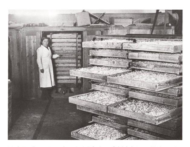
8 Für die Herstellung von Körperseifen werden die Seifenplatten aufgehobelt, die Späne auf Hurden ausgelegt und in Heissluftschränken getrocknet. Etwa ab Anfang der 1960er-Jahre werden die Späne direkt auf dem Bandtrockner aus der heissen Grundseife hergestellt. Chargenweise werden nun Parfum, Farbe und weitere Zusätze eingearbeitet.
