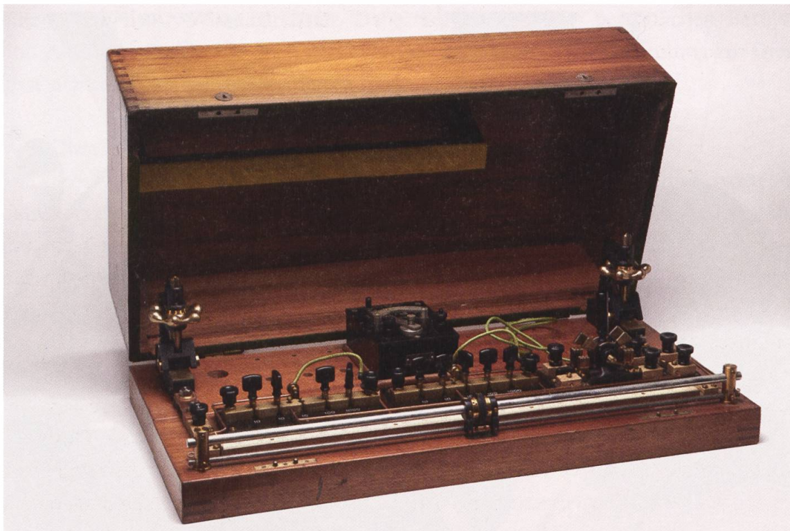
1 Messbrücke aus der BBC, Hersteller: Siemens-Halske, 1910er-Jahre, Historisches Museum Baden (Foto: Nici Jost).
