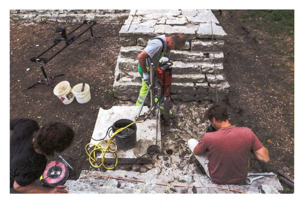
2 Rheinfelden-Pferrichgraben. Blick auf den Eingangsbereich des spätrömischen Wachturms. Mörtelproben werden mittels Kernbohrungen für die <sup>14</sup>C- beziehungsweise Radiokarbonanalysen entnommen. © Vindonissa-Professur, Universität Basel.
