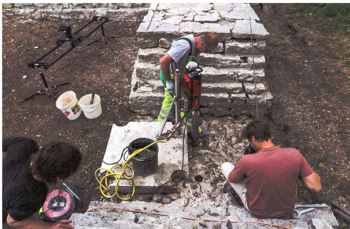
2 Rheinfelden-Pferrichgraben. Blick auf den Eingangsbereich des spätrömischen Wachturms. Mörtelproben werden mittels Kernbohrungen für die ^{14}\text{C} - beziehungsweise Radiokarbonanalysen entnommen. © Vindonissa-Professur, Universität Basel.
