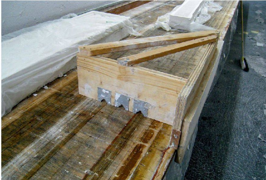
12 Schablone mit Schlitten zum Ziehen von Profilleisten in der Werkstatt des eidg. dipl. Stuckateurs Frank Jäggi, Langenthal (Foto: Kantonale Denkmalpflege Aargau, Franziska Schärer, 2011).
