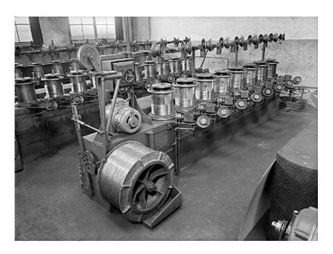
2 Drahtzüge der Firma Vogt, spätere 1930er-Jahre. Die von Ingenieur Kurt Vogt konzipierten und im Werk gebauten Anlagen waren – in immer wieder verbesserter Form – über Jahrzehnte im Einsatz.
