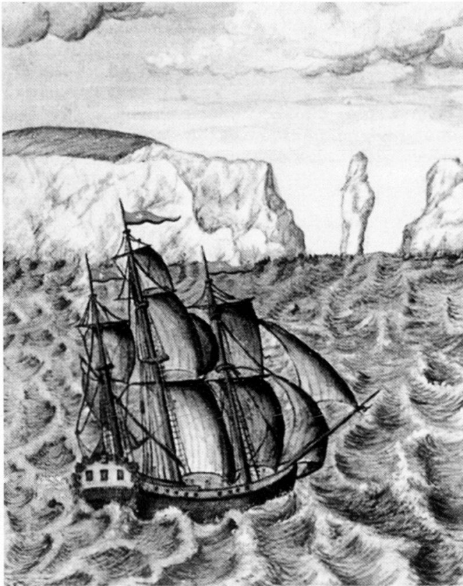
Auswandererschiff vor der Isle of Wight. Die hölzerne Dreimast-Bark mit zwei Decks war in der ersten Hälfte des 19. Jahrhunderts das gebräuchlichste Frachtschiff. Die Bark hatte einen relativ grossen Laderaum. Sie unterschied sich vom Vollschiff dadurch, dass nur Fock- und Grossmast mit Rahsegeln bestückt waren, während der hintere Mast (Besanmast) Schratsegel trug. Dadurch waren die Barkschiffe einfacher zu bedienen und kamen mit einer kleineren Besatzung (15–20 Mann) aus, was sich günstig auf die Frachtkosten auswirkte.
