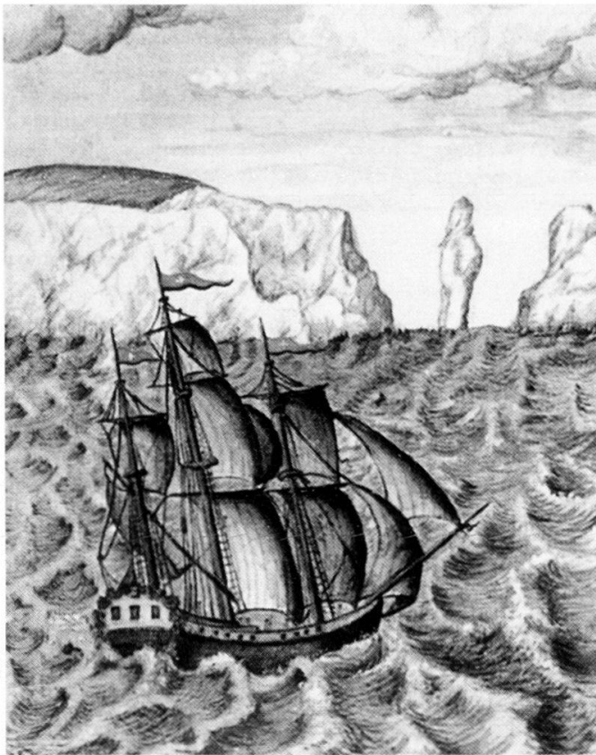
Auswandererschiff vor der Isle of Wight. Die hölzerne Dreimast-Bark mit zwei Decks war in der ersten Hälfte des 19. Jahrhunderts das gebräuchlichste Frachtschiff. Die Bark hatte einen relativ grossen Laderaum. Sie unterschied sich vom Vollschiiff dadurch, dass nur Fock- und Grossmast mit Rahsegeln bestückt waren, während der hintere Mast (Besanmast) Schratsegel trug. Dadurch waren die Barkschiffe einfacher zu bedienen und kamen mit einer kleineren Besatzung (15–20 Mann) aus, was sich günstig auf die Frachtkosten auswirkte.
