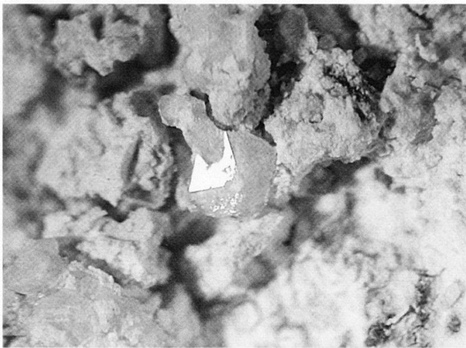
2 Im Zentrum ein gut ausgebildeter dipyramidaler Calciumoxalatkristall (Weddelit), umgeben von Mörtel, der durch Pflanzenreste (Rinde) verfärbt ist. Aufsicht unter dem Stereomikroskop mit Streiflicht. Bildbreite knapp 3 mm.
