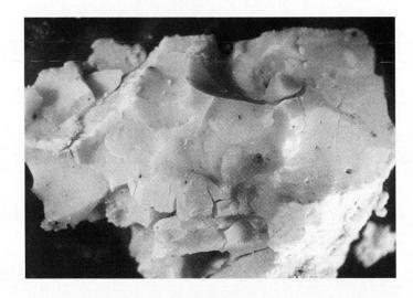
5 Die frischen Bruchflächen der sehr feuchten Masse sind muschelig, ein Hinweis auf ein dichtes Material. Aufsicht unter dem Stereomikroskop. Bildbreite etwa 2 cm.
