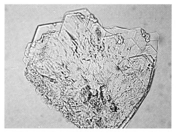
4 Ein Aggregat parallelverwachsener, hexagonaler Brucitplättchen aus einem Hohlraum im Mörtel. Streupräparat unter dem Mikroskop mit parallelen Polarisatoren. Bildbreite etwa 0,3 mm.
