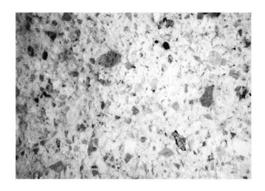
7 Frische Bruchfläche von der grauen Mörtelschicht unter dem gelöschten Kalk. Der Zuschlag besteht aus sehr feinkörnigem Sand. Aufsicht unter dem Stereomikroskop. Bildbreite 7 mm.
