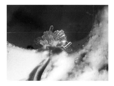
3 Hohlraum in einem Kalkspatzen mit prismatischen Calcitkristallen in rosettenartiger Anordnung. Unter dem Stereomikroskop mit Streiflicht. Bildbreite etwa 1 cm.
