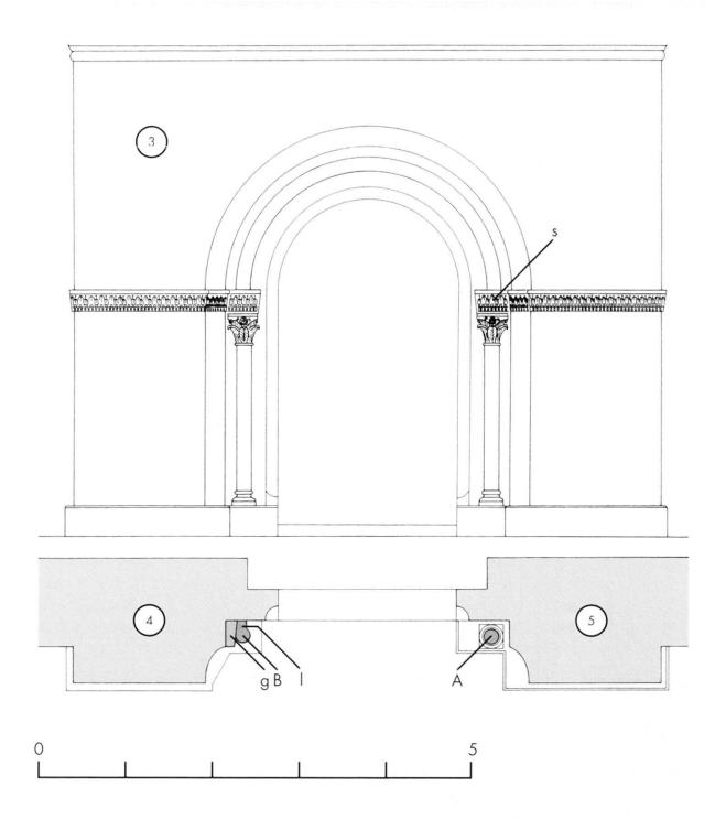
**3-5** Rheinfelden, Westportal. Aufriss des Rundbogenrahmens und des rechteckigen Mauerblocks. Mutmassliche Rekonstruktion des originalen Zustandes. – Linksseitiger Grundriss der Bogenzone, Rekonstruktionsversuch. – Rechtsseitiger Grundriss der Gewändezone, Rekonstruktionsversuch.
