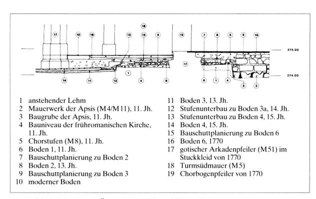
Abb. 1: Schnitt West-Ost am Übergang vom Mittelschiff zum Chor
