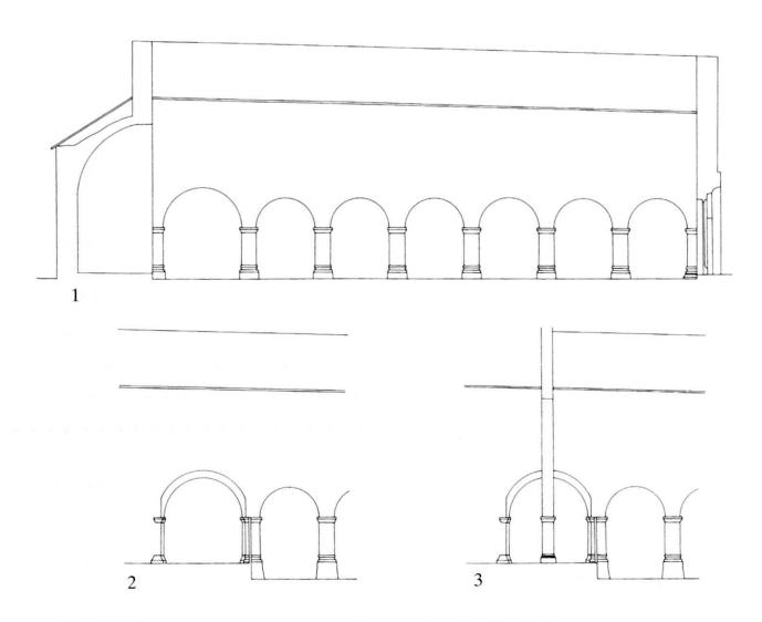
Abb. 19: Rekonstruktion der südlichen Arkaden.
