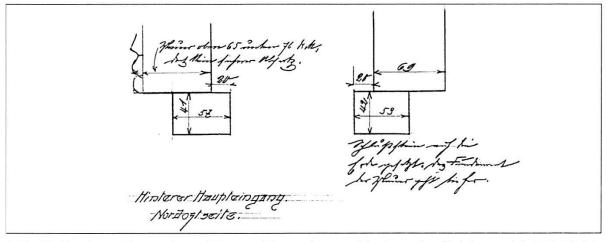
Abb. 39 Döttingen-Sunnenberg. Hinterer Haupteingang. Nordostseite. Zeichnung M. 1:50 (Original M. 1:20) J. Villiger 1916. Planinschriften: Mauer oben 65, unten 76 dick, doch kein sicherer Absatz. – Schlussstein auf die Erde gesetzt. Das Fundament der Mauer geht bis hier.
