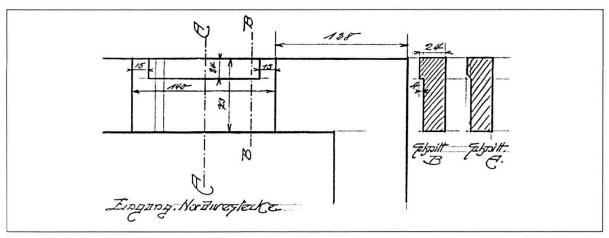
Abb. 38 Döttingen-Sunnenberg. Eingang Nordwestecke, Grundriss und Schnitte M. 1:50. Zeichnung (Original M. 1:20) J. Villiger 1916. Bemerkung unter der Zeichnung: Die Schwelle ist teilweise defekt.
