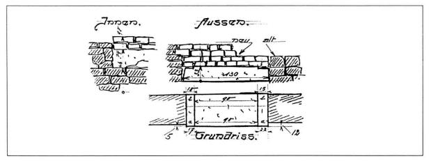
Abb. 37 Döttingen-Sunnenberg. Eingang Westtrakt, Grundriss und Ansichten M. 1:50. Skizze (Original M. 1:20) J. Villiger 1916. Bemerkung unter der Zeichnung: Einschnitt bei a 2 cm, bei b 1 cm tief. Hier war das Türgewände aufgesetzt.
