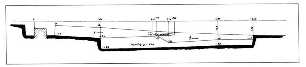
Abb. 21 Zurzach-Brüggliwiesen. «Schnitt durch die Böschung beim nordwestlichen Gebäude auf Parc. 248. (Gebäude C) 21. Oct. 1915. Die Schicht Mörtelschutt findet sich auch in mehreren Sondierschlitzen östlich und westlich, jedoch liegt sie dort mehr nach der Krone der Böschung.» Zeichnung M. 1:50, Abbildung unmassstäblich.
