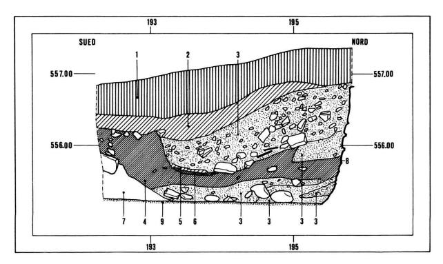
Abb. 3. Schnitt durch den Kalkbrennofen. Massstab 1:50. 1: Humus; 2: Humose Einfüllung (Fundschicht); 3: Bauschutt (Fundschicht); 4: Humose Einfüllung (Fundschicht); 5: Lehm; 6: Holzkohle; 7: Ofenlehm; 8: Ofenwand; 9: harte Kalkschicht (Sohle des Ofens).
