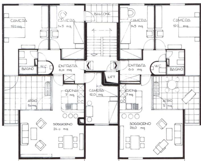
**5** Dettaglio pianta primo e terzo piano.
