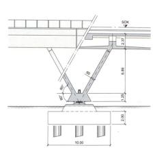
Prospetto e sezione longitudinale su pila
