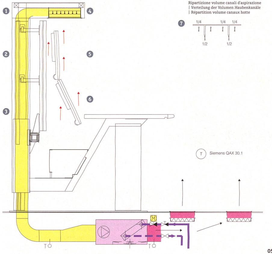
Schema riferito all'efficienza 100%, con il calore schermo disperso in ambiente l'efficienza scende al 50% | Schema für 100% Effizienz, wird Bildschirmwärme an die Luft abgegeben, sinkt die Effizienz auf 50% | Schéma rapporté à l'efficience 100%, avec la chaleur de l'écran dispersée dans l'environnement l'efficience descend à 50%
