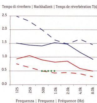
06 Andamento del  $T_{\text{medio}}$  prima e dopo l'inserimento dell'arredamento | Hallzeit vor und nach der Innenausstattung | Evolution du temps de réverbération avant et après la mise en place du mobilier
