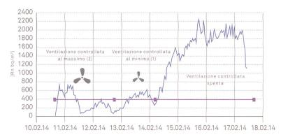
Figura 2. Concentrazioni radon a seguito dello spegnimento del sistema di ventilazione
