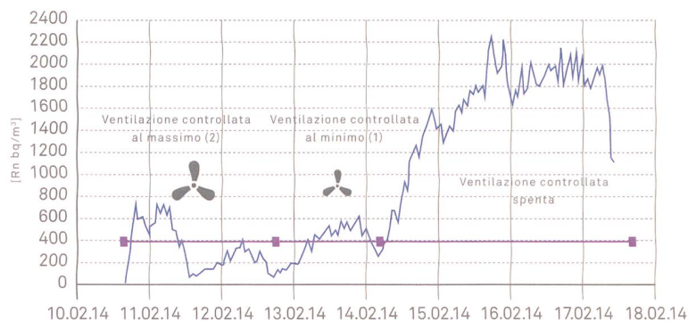
Figura 2. Concentrazioni radon a seguito dello spegnimento del sistema di ventilazione
