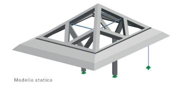
cio inclinato del pilastro e una forza ausiliaria di bilanciamento indotta attivamente per mezzo di un tirante posto in cucina nell'angolo della facciata. L'efficacia dei provvedimenti intrapresi ha trovato ampio riscontro con la deformazione verticale misurata lungo la facciata al termine della costruzione.
