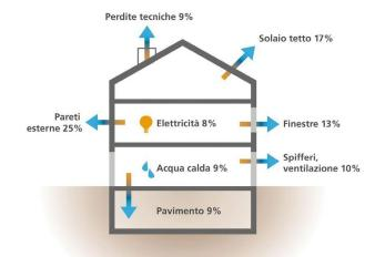
Le perdite termiche attraverso l'involucro e le utenze sono così ripartite (considerando l'energia complessiva fornita per il riscaldamento, l'acqua calda sanitaria e l'elettricità). Fonte: Opuscolo «Rinnovare gli edifici» di SvizzeraEnergia
