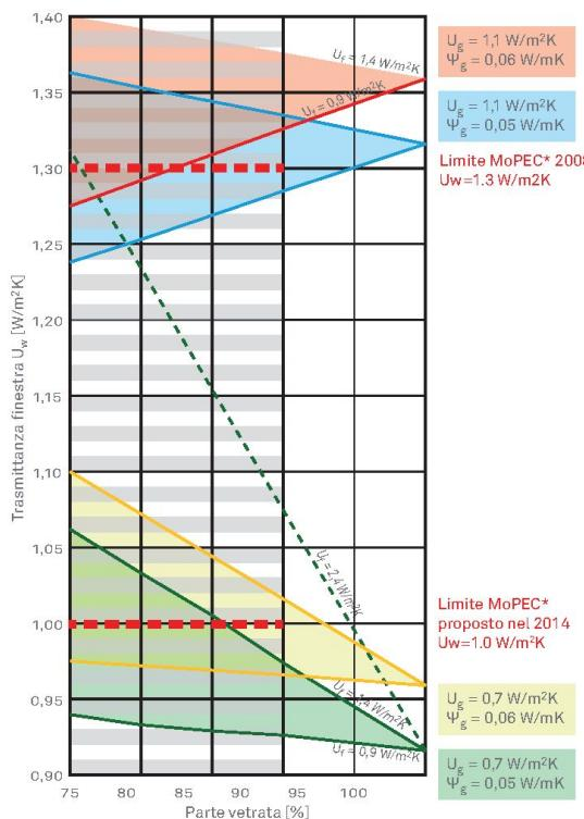
I diagrammi mostrano la dipendenza del valore complessivo della finestra ( $U_w$ ) dal rapporto tra le superfici del vetro e quella dell'apertura, dalle caratteristiche termiche del telaio ( $U_f$ ), del vetro ( $U_g$ ) e del distanziatore ( $\Psi_g$ ). Scelto il tipo di vetro ( $U_g$ ) con il relativo distanziatore ( $\Psi_g$ ) e il tipo di telaio ( $U_f$ ), si individua poi la % di parte vetrata. È quindi possibile leggere sull'asse il valore  $U_w$  complessivo della finestra.
