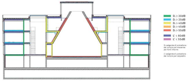
Elaborazione della sezione di progetto B-B. Requisiti acustici passivi degli elementi edili
