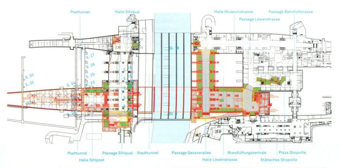
Pianta del livello dei negozi. I 23 accessi dal livello superiore avvengono sono distribuiti da 4 passaggi trasversali. Da ovest, il settore Sihlpost, lo Stadttunnel, il canale per lo scorrimento della Sihl, ed il settore Hauptbahnof
