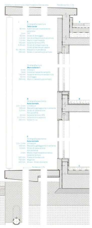
Cez, Calderan Zanovello Architetti Scuola elementare, Vipiteno Dettaglio del tetto verde (16 cm. isolamento in XPS), parete esterna (cappotto termico da 14 cm.) e del basamento dell'edificio (12 cm. di isolamento).
