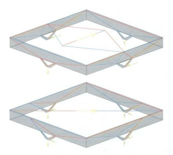
Das Tragwerk des Gebäudes aus Stahlbeton und vorgespanntem Beton besteht aus einem Sockelfundament und aus einem Volumen, das auf dem Sockel ruht und innen einen leeren Raum bildet, in dem die sportlichen Aktivitäten stattfinden. Vier zentral zu den Fassaden angeordnete V-förmige Pfeiler stützen die Balken der Außenwände, auf denen die Dachkonstruktion der Sporthalle aufliegt.
