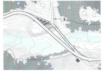
Si è pertanto optato per una struttura monolitica in calcestruzzo armato precompresso con una campata unica che garantisse la massima trasparenza in modo da non nascondere l'antico ponte con il suo caratteristico appoggio centrale.
