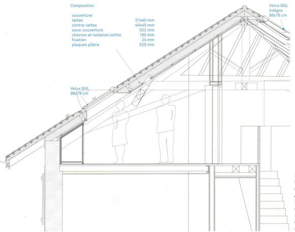
Riusare, da municipio ad abitazioni a Troinex Atelier Bonnet Intervento di risanamento energetico parziale, dettaglio ricostruzione tetto in legno (160 mm. di spessore di isolamento tra le travi)
