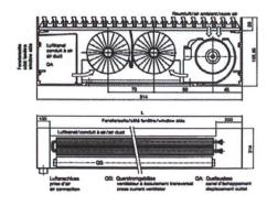
Il concetto dei convettori incassati a pavimento con buona reazione e trasmissione termica riscaldamento dell'aria complementare con una potenza di 3 kW, tramite il circuito idraulico.
