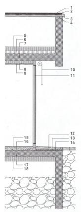
Sezione di dettaglio della struttura dell'edificio esistente e degli elementi utilizzati nel risanamento termico/funzionale
