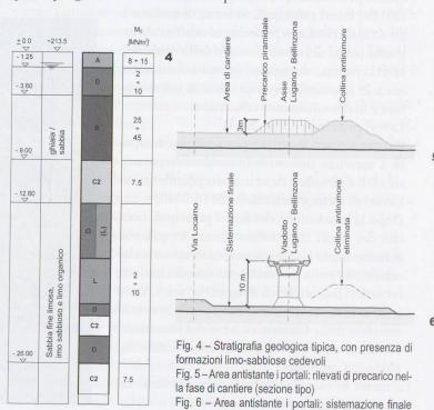
Oltre ad un monitoraggio dei cedimenti in superficie si procede pure, tramite l'installazione di estensimetri multibase profondi fino a circa 30 m, alla misurazione dei cedimenti a varie profondità e in corrispondenza di diverse stratificazioni geologiche. Con tale monitoraggio è possibile identificare gli strati più cedevoli e l'entità delle deformazioni profonde al fine di ottimizzare ad esempio la progettazione e realizzazione delle opere di fondazione dei viadotti.
