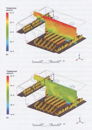
Fig. 4 – Distribuzione della temperatura in una sala conferenze: raffronto di due varianti di ventilazione. Sopra: configurazione originale. Sotto: risultato dell'ottimizzazione
