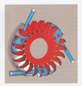
Fig. 3 – Studio dell'interazione getto-girante di una turbina Pelton. Il flusso d'acqua è a superficie libera (calcolo eseguito al CSCS di Manno in collaborazione con Andritz Hydro)
