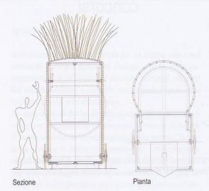
Struttura e materiali: struttura portante in acciaio, involucro in legno rivestito con listelli di bambù.
