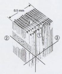
Fig. 1 – Struttura ingrandita del legno d'abete. 1- direzione longitudinale, 2- direzione radiale, 3- direzione tangenziale
