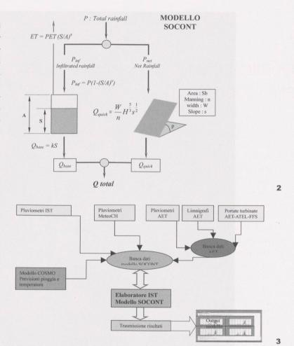
Fig. 2 – Diagramma di flusso della procedura di calcolo del modello SOCONT Fig. 3 – Struttura di interscambio e trasmissione dati per il modello di previsione delle portate in tempo reale
