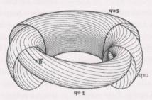
Fig.9 – Illustrazione delle superfici magnetiche della configurazione tokamak: sono indicate le superfici a linee B chiuse su cui q=1/1,2/1,5/1.
