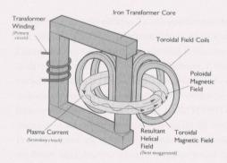
Fig.8 – Schema della struttura di un tokamak, con le bobine per generare il campo toroidale B, ed il circuito trasformatore primario per indurre la corrente I<sub>n</sub> nel plasma
