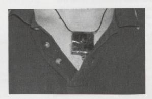
Fig. 2 – Esempio di sensore indossabile per la misura di temperatura e sudorazione corpore
