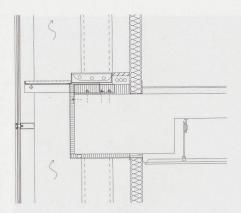
Dettaglio fissaggio soletta tipo
