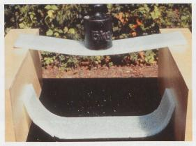
Fig. 2 – Capacità portante di pannelli in vetro stratificato completamente rotti. Mentre la lastra in primo piano è collassata, pochi secondo dopo tutte e due le lastre sono state distrutte volontariamente. Quella in secondo piano, pure completamente rotta, resiste ininterrotamentee dal 1998 sempre con un carico di 5Kg.
