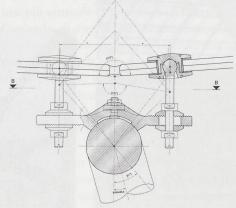
Fig. 8 – Copertura Abbazia di Neumünster, Lussemburgo (1998-2003), RFR, dettaglio
