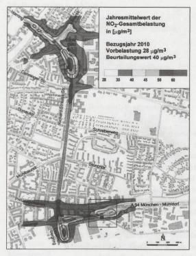
Fig. 5 — Settore est del «Mittlerer Ring» di Monaco. Concentrazione media di NO<sub>2</sub>, anno 2010 (modello gaussiano). Il riquadro nella parte bassa corrisponde al settore calcolato con il modello tridimensionale.
