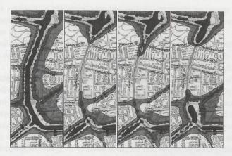
Fig. 4 – Settore sud-ovest del «Mittlerer Ring» di Monaco. Concentrazione media di NO<sub>2</sub>, anno 2010, senza galleria (a sinistra) e con tre diverse varianti di galleria, caratterizzate da diverse posizioni dei portali (modello gaussiano)
