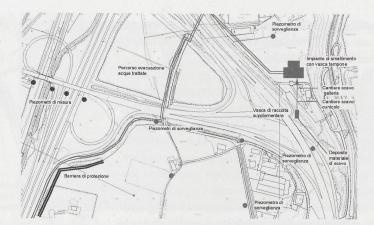
Fig. 11 - Misure di protezione e sorveglianza dell'acquifero durante la fase di cantiere
