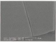
Fig. 3 – Esempi di campioni realizzati e micrografia al microscopio elettronico a scansione (SEM) di un rivestimento realizzato su alluminio decappato
