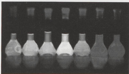
Fig. 2 – Bottiglie con contenuto chimico identico: con una sospensione di nanoparticelle di cadmio-selenid. L'unica differenza è nella grandezza delle particelle. Fonte: Nanosolutions GmbH, Hamburg
