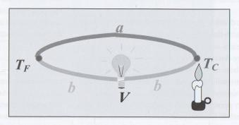
Fig – 1: L'effetto Seebeck: una tensione elettrica V viene generata riscaldando una delle giunzioni di un circuito formato da due metalli diversi (temperatura  $T_C > T_F$ )
