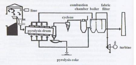
Fig. 5 – Schema di processo di gassificazione-pirolisi
